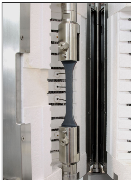
II) Hochtemperatur-Probenadapter für Schulterproben mit Bohrung und fixen Thermoelementen (angesetzt)
