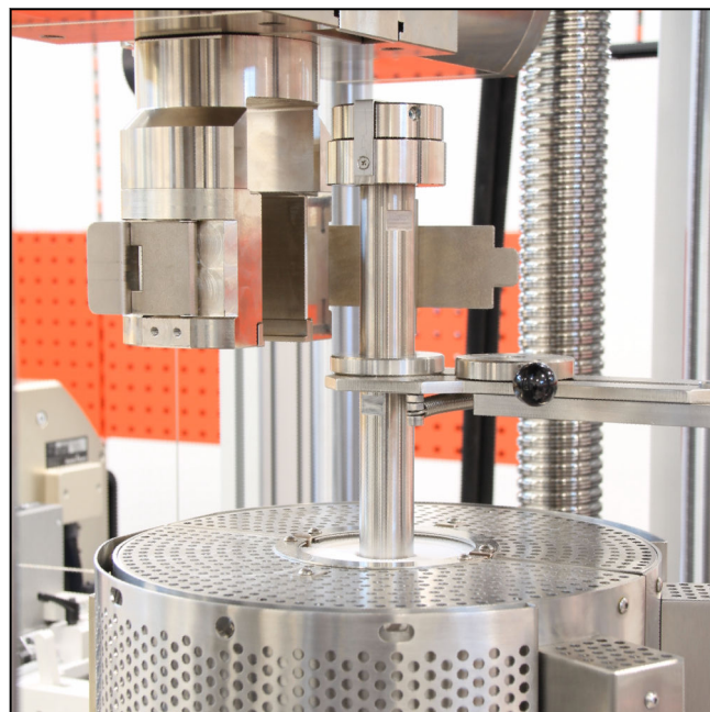
Hochtemperatur-Laststrang wird in die Hochtemperatur-Zuggestängeaufnahme eingeführt
