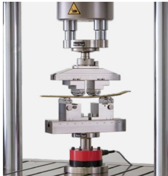
4-Punkt Biegevorrichtung zur Prüfung von Knochenplatten nach ASTM F382
