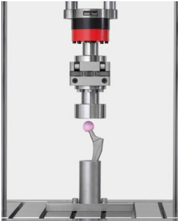
Prüfvorrichtung zur Prüfung einer Hüftendoprothese nach ISO 7206-4
