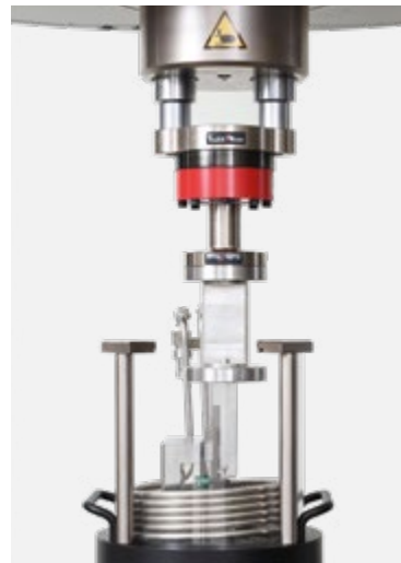
Prüfvorrichtung von Unterbaugruppen nach ASTM F1798 mit Temperierbad
