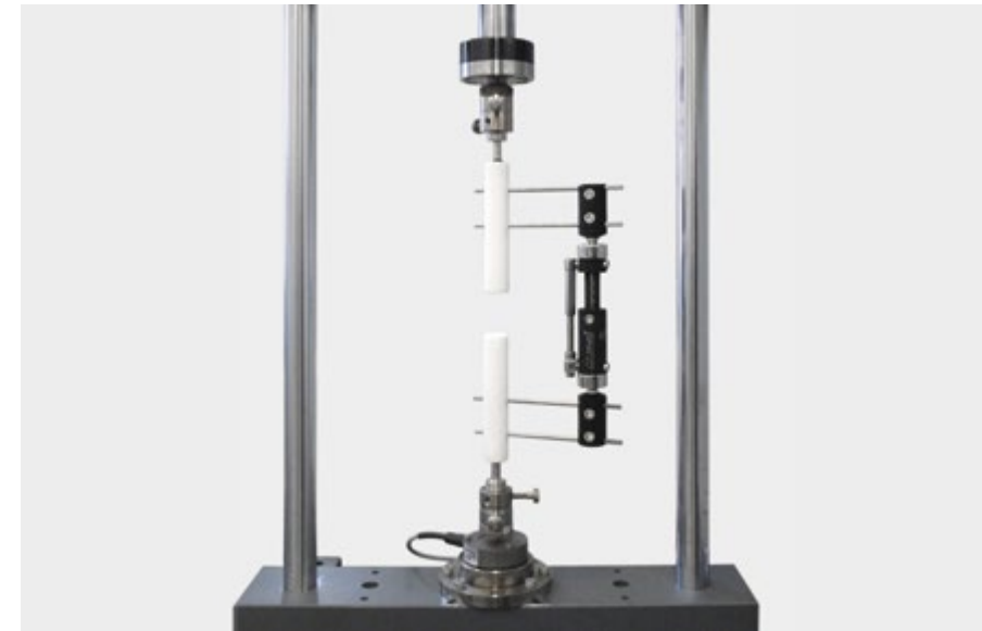
Prüfvorrichtung zur Prüfung von externen Fixateuren nach ASTM F1541
