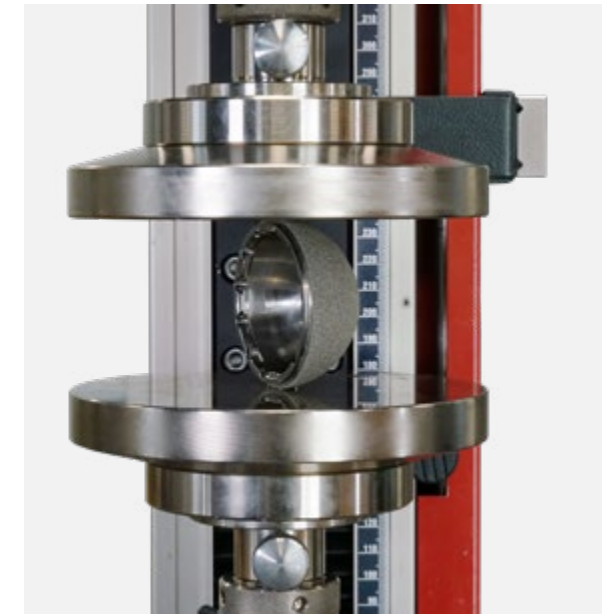
2-Punkt-Biegevorrichtung für Prüfung von Hüftpfannen nach ISO 7206-12
