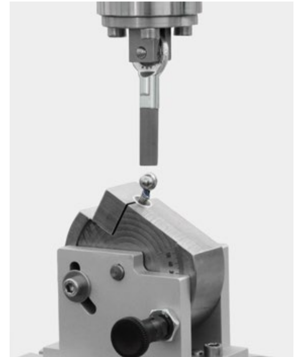
Prüfvorrichtung zur Prüfung nach ISO 14801
