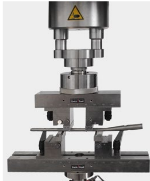
4-Punkt Biegevorrichtung zur Prüfung von Knochennägeln nach ASTM F1264
