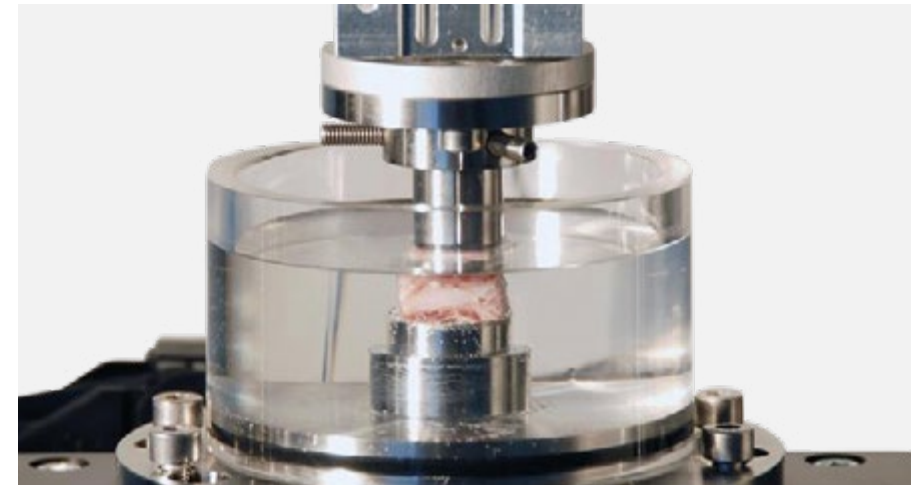
Ermittlung der Schereigenschaften von Weichgewebe mittels einer speziellen tri-axialen Prüfvorrichtung
