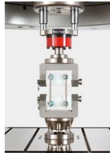
Prüfvorrichtung für Wirbelsäulen-Konstrukte nach ASTM F1717 und ASTM F2706
