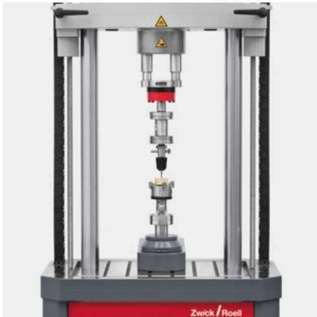
Prüfung von Knochenschrauben nach ASTM F543 mit einer elektrondynamischen Prüfmaschine Typ LTM
