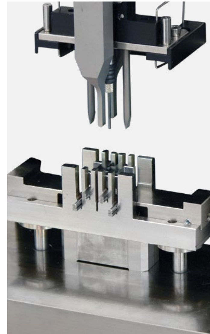
4-Punkt Biegevorrichtung zur Prüfung von Dentalkeramiken
