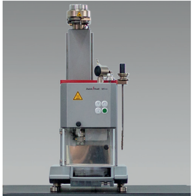
Bild 2: Mflow mit Gewichtsanhebung und Vorrichtung zum Halten des Prüfkolbens in Vorheizphase
